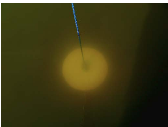
10.attēls. Lubāna ziemeļaustrumu daļa, 10.09.2021. caurredzamība 1,05 m. Seki disks iegremdēts 52 cm dziļumā.
