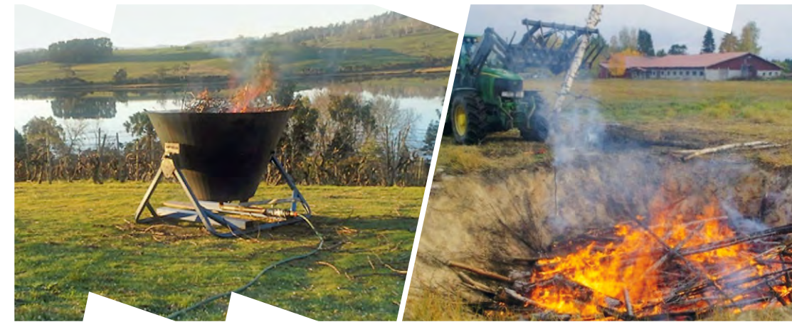
3. attēls. Pa kreisi: Kon-Tiki ceplis Tasmānijā (Foto: Franks Strī ( Frank Strie )), viens no pirmajiem modeļiem karstās bioogles aktivizēšanai ar ūdens dzesēšanu no apakšas uz augšu. Foto no [18]. Pa labi: liela mēroga pirolīze augsnes bedrē ir efektīvs veids, kā bioogles iegūt saimniecībā – tomēr ir ļoti svarīgi darboties ar labu garu instrumentu komplektu biomasas sakārtošanai vienmērīgās kārtās, lai izvairītos no dūmu emisijām. Ieteicams arī augsnes bedres sienas apklāt ar māla apmetumu, lai atvieglotu šķidrā veidā aktivizēto bioogļu savākšanu pēc dzesēšanas. Fermas mēroga pirolīzes pasākums Liperi, Somijā, 2019. gada oktobrī. Foto: Priits Tameorgs ( Priit Tammeorg )
