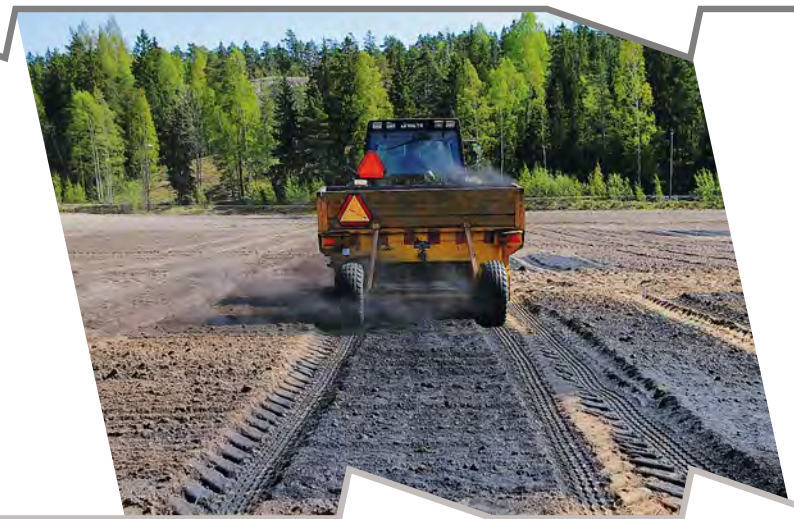
5. attēls. Smilšu izkaldētāja izmantošana tīras skujkoku bioogļu (aptuvenais mitruma sastāvs 30 %) uzklāšanai uz eksperimenta lauka Helsinkos. Pievērsiet uzmanību uzklāšanas precizitātei, ko nodrošina minimālais putekļu daudzums. Foto: Prīts Tameorgs
