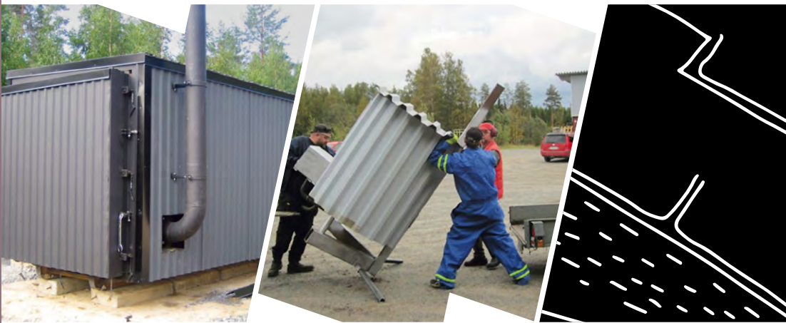
2. attēls. Divu veidu sērijveida retortes, kas piemērotas decentralizētai bioogļu ražošanai. Foto: Tomo Lepanens ( Tuomo Leppänen )
