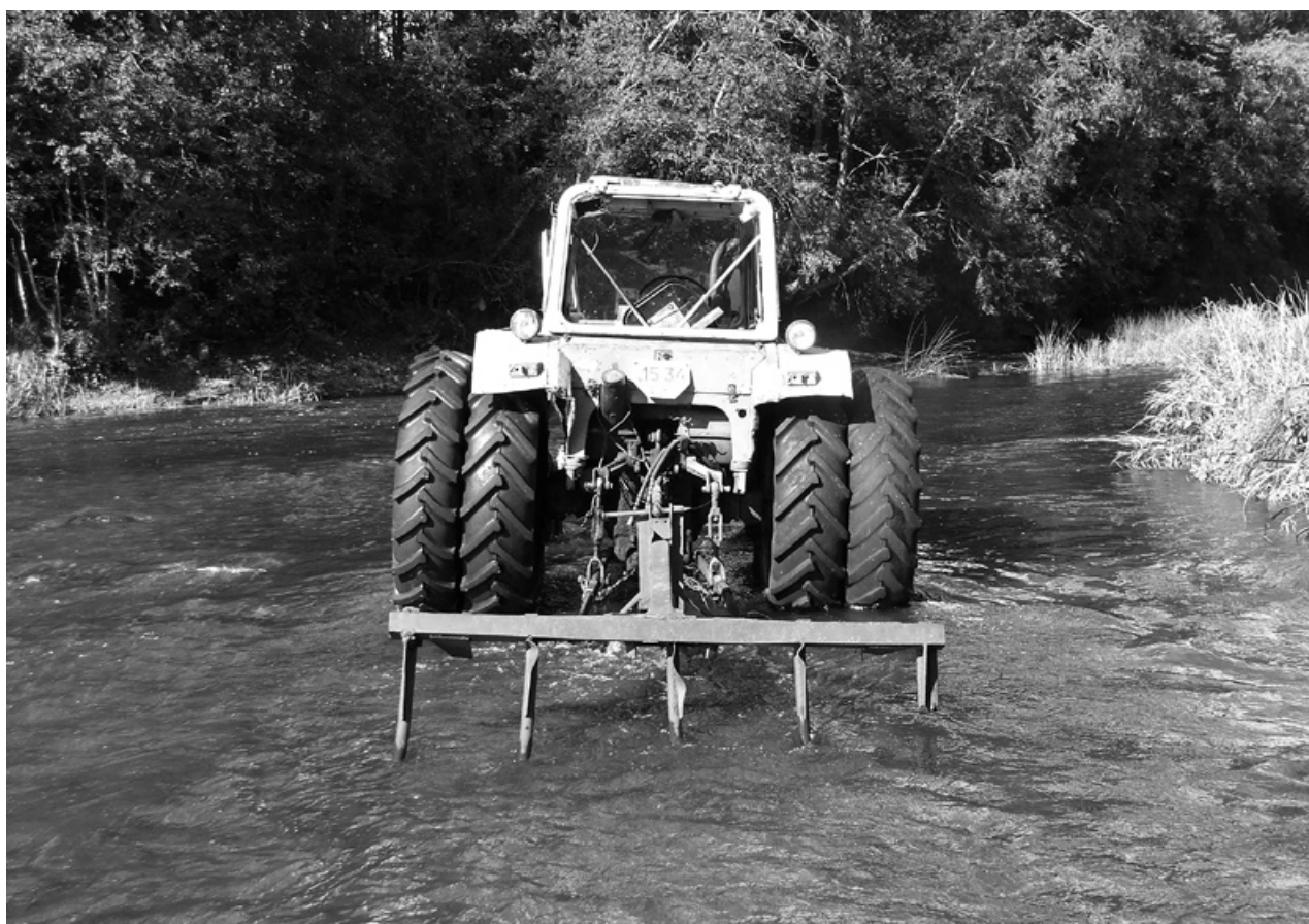
2. attēls. Tehnika gultnes irdināšanai un ūdensaugu sakņu sistēmas iznīcināšanai. Darba dziļums līdz 0,5 metri.
