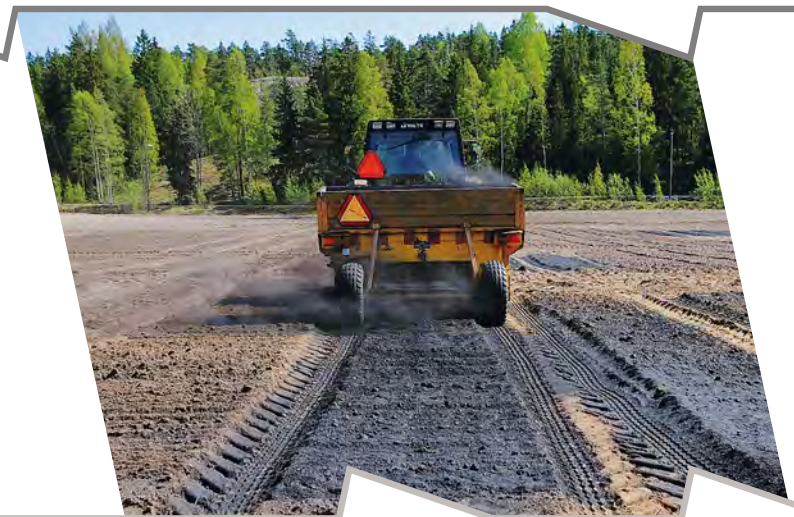
5. attēls. Smilšu izklaidētāja izmantošana tīras skujkoku bioogļu (aptuvenais mitruma sastāvs 30 %) uzklāšanai uz eksperimenta lauka Helsinkos. Pievērsiet uzmanību uzklāšanas precizitātei, ko nodrošina minimālais putekļu daudzums. Foto: Priits Tameorgs
