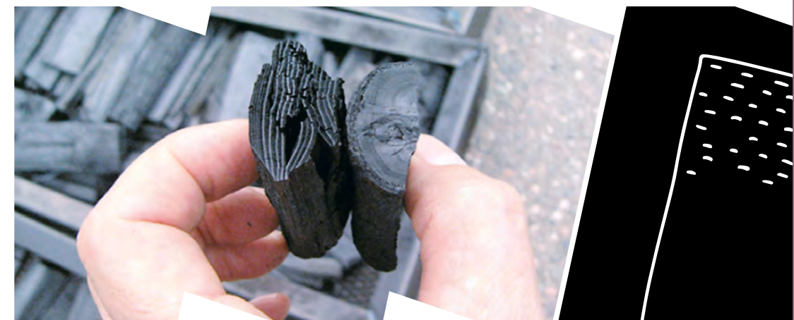
1. attēls. Bioogles no egles (pa kreisi) un bērza (pa labi) izskatās atšķirīgi, jo koksnes sugām ir raksturīgi augšanas gredzeni un koksnes šūnu kompaktums. Foto: Kari Tiilikkala
