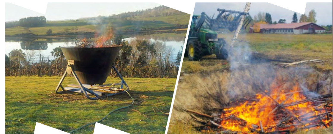
3. attēls. Pa kreisi: Kon-Tiki cepis Tasmānijā (Foto: Franks Strī ( Frank Strie )), viens no pirmajiem modeļiem karstās bioogles aktivizēšanai ar ūdens dzesēšanu no apakšas uz augšu. Foto no [18]. Pa labi: liela mēroga pirolīze augsnes bedrē ir efektīvs veids, kā bioogles iegūt saimniecībā – tomēr ir ļoti svarīgi darboties ar labu garu instrumentu komplektu biomasas sakārtošanai vienmērīgās kārtās, lai izvairītos no dūmu emisijām. Ieteicams arī augsnes bedres sienas apklāt ar māla apmetumu, lai atvieglotu šķidrā veidā aktivizēto bioogļu savākšanu pēc dzesēšanas. Fermas mēroga pirolīzes pasākums Liperi, Somijā, 2019. gada oktobrī. Foto: Priits Tameorgs ( Priit Tammeorg )
