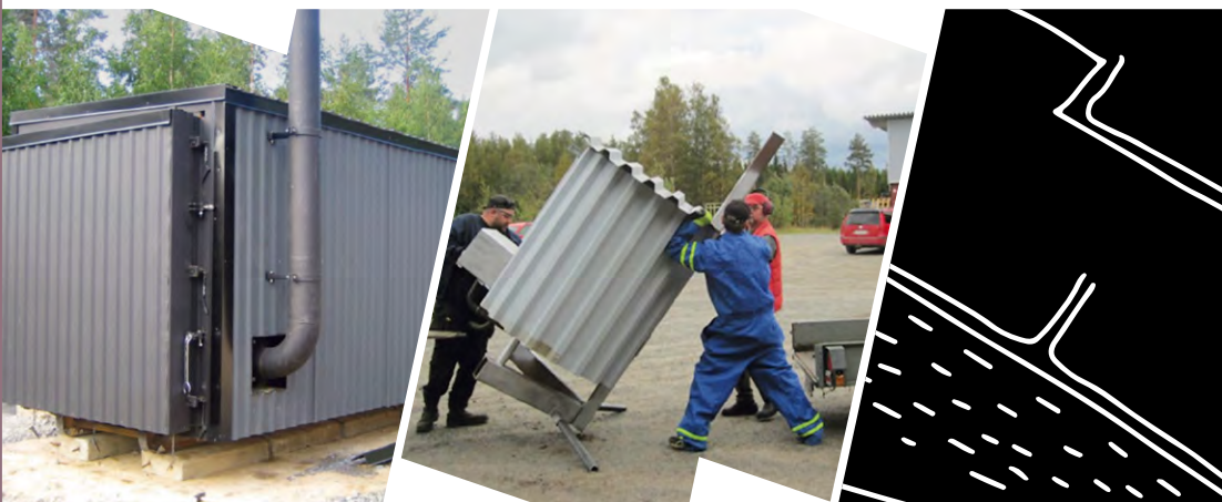
2. attēls. Divu veidu sērijveida retortes, kas piemērotas decentralizētai bioogļu ražošanai. Foto: Tomo Lapanens ( Tuomo Leppänen )
